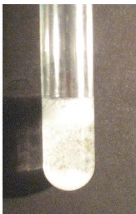
Fig. 9.- Reacción positiva para la presencia de carbonatos o bicarbonatos; la efervescencia es producida por la liberación de CO<sub>2</sub>.
